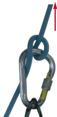
C09-17 Posizione del mezzo barcaiolo con rami di corda, in entrata e uscita dal freno, posti a 180°
