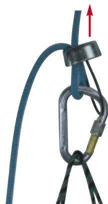
C09-17 Posizione del tuber con rami di corda, in entrata e uscita dal freno, posti a 180°
