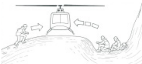
C15-15 Avvicinamento su pendio
